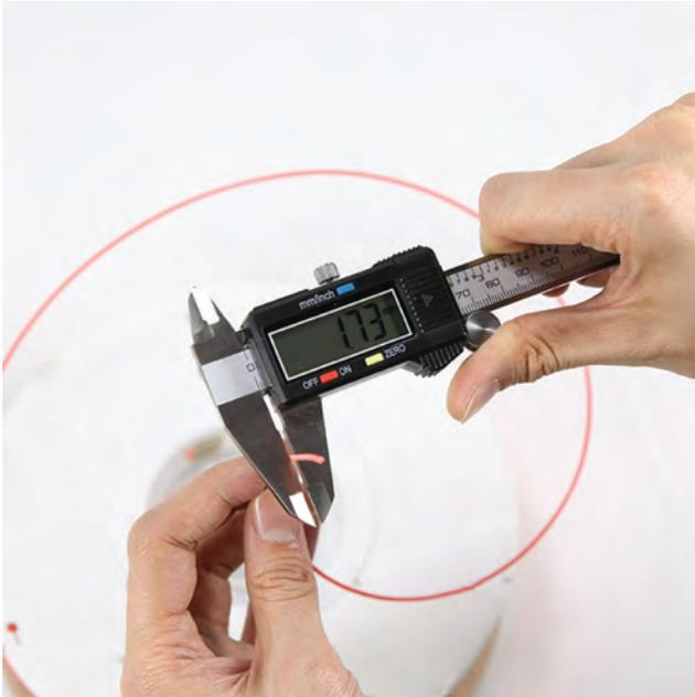
2. Prenez une seconde mesure à un autre endroit du filament. Nous avons ici 1.74 mm.
