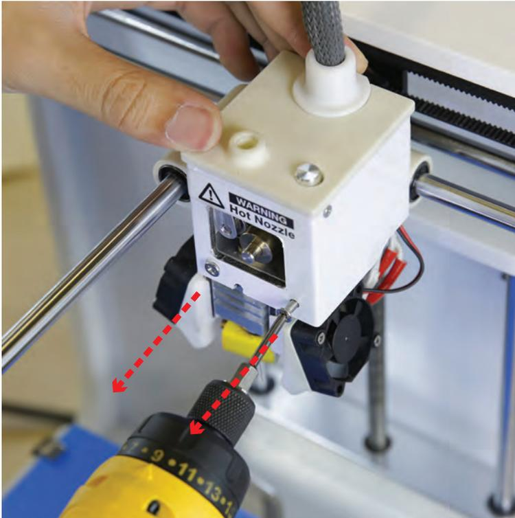
S'assurer qu'aucun filament n'est branché sur la tête d'impression, et laisser la tête d'impression refroidir avant tout remplacement.
