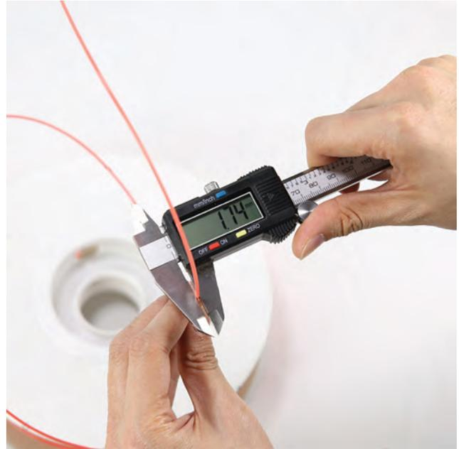
3. Prenez une dernière mesure sur une nouvelle section du filament. Nous avons ici 1.72 mm.
